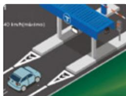
2. Antena y transmisor intercambian una señal. El sistema identifica el dispositivo Quick Pass instalado en el automóvil.
