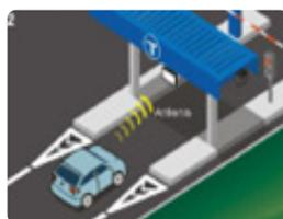
3. El sistema carga el monto del peaje en la cuenta del usuario de Quick Pass. El dispositivo emitirá un pitido en señal de que la transacción se efectuó exitosamente.
